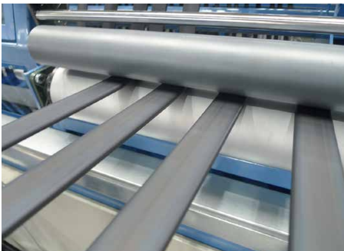
Abb. 5: Exakt dimensionierte Fütterstreifen nach dem Strainer- und Kühlprozess
