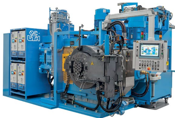
Bild 8: Roll-ex 1000 TRF für das Feinstrainern in der Misch- linie mit 10.000 kg/h.
