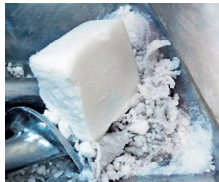
Bild 1: Schwierige Materialien bzw. Ausgangsformen können diskontinuierlich aufgegeben werden – v.l.n.r.: Polyisobutylen (PIB), Butyl-Kautschuk, SBR-Ballen
