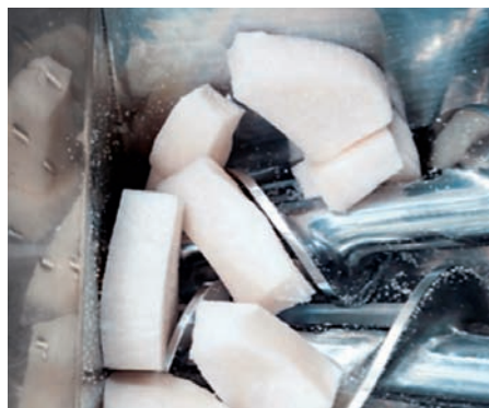
Bild 1: Schwierige Materialien bzw. Ausgangsformen können diskontinuierlich aufgegeben werden – v.l.n.r.: Polyisobutylen (PIB), Butyl-Kautschuk, SBR-Ballen
