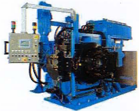
Der Zahnradextruder Roll-ex 600TRF zum Inline-Feinstrainern bewältigt bis zu 6.000 kg Mischung pro Stunde Foto: Uth
