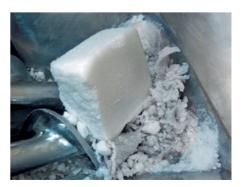
Bild 1: Schwierige Materialien bzw. Ausgangsformen können diskontinuierlich aufgegeben werden – v.l.n.r.: Polyisobutylen (PIB), Butyl-Kautschuk, SBR-Ballen (Bild-LITH GmbH)
