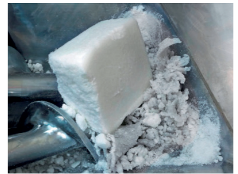
Bild 1: Schwierige Materialien bzw. Ausgangsformen können diskontinuierlich aufgegeben werden – v.l.n.r.: Polyisobutyl (PIB), Butyl-Kautschuk, SBR-Ballen (Bild: UTH GmbH)
