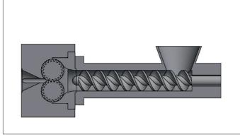
Bild 2: Schematische Darstellung: Einschnecken-Fütteraggregat und Zahnradpumpe
