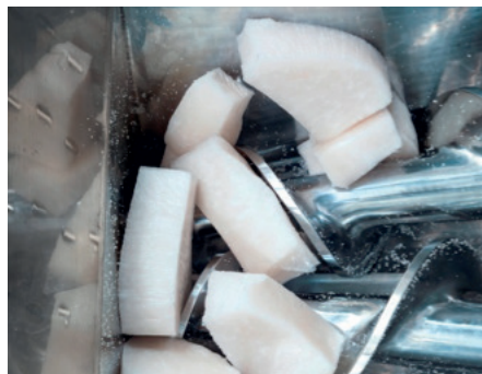
Bild 1: Schwierige Materialien bzw. Ausgangsformen können diskontinuierlich aufgegeben werden – v.l.n.r.: Polyisobutyl (PIB), Butyl-Kautschuk, SBR-Ballen (Bild: UTH GmbH)
