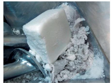
**Bild 1: Schwierige Materialien bzw. Ausgangsformen können diskontinuierlich aufgegeben werden – v.l.n.r.: Polyisobutyl (PIB), Butyl-Kautschuk, SBR-Ballen**
